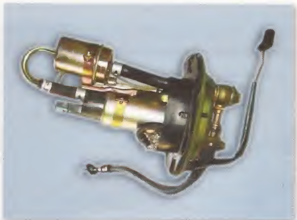
Bomba eléctrica de gasolina
